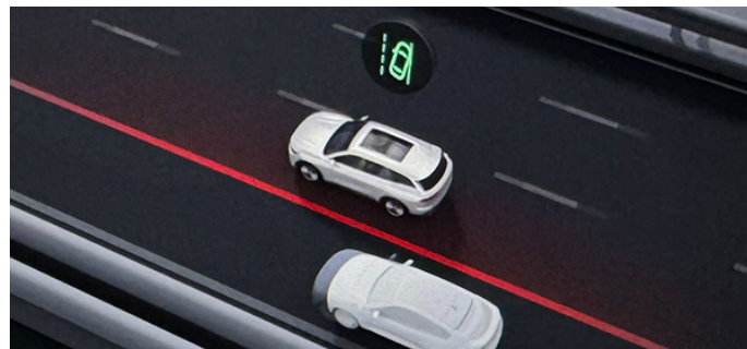
Corrección de carril de emergencia
